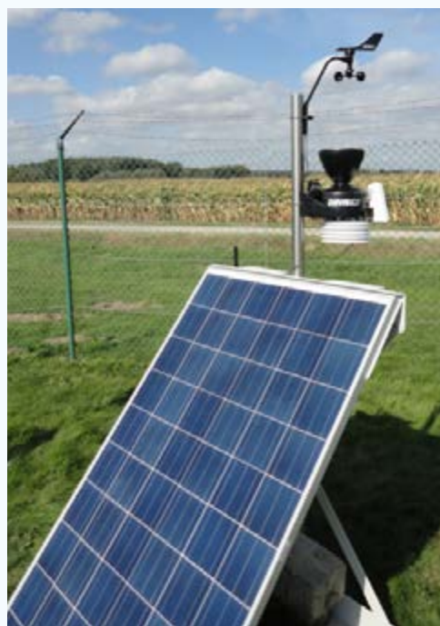
Automatisch weerstation zoals ze geplaatst zullen worden op verschillende locaties verspreid in Vlaanderen.
