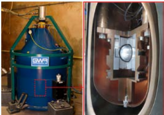
Figuur 2: De supergeleidende gravimeter van Membach. Rechts: Detailtekening van de sensor met de zweevende bol. Foto links: E. Coveliers
