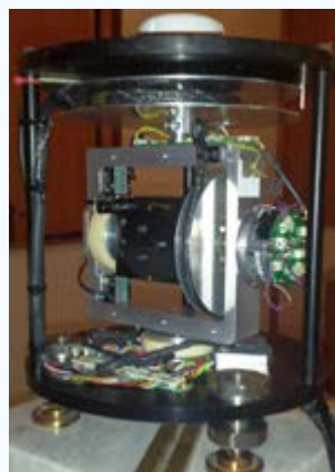
Figuur 1: De GYRODIF die op Antarctica werd geïnstalleerd. Het toestel meet automatisch: De richting van het geografische noorden, van het magnetische noorden en de magnetische inclinatie.
